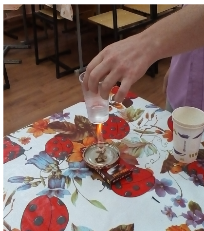
Рис. 1. Стакан, який не плавиться. Обладнання: пластиковий стакан, вода, сухий спирт, сірники.
