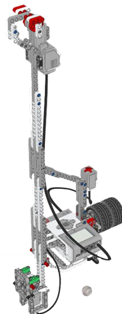
Рис. Д.8.1. Модель експериментальної установки для дослідження сили тяжіння
