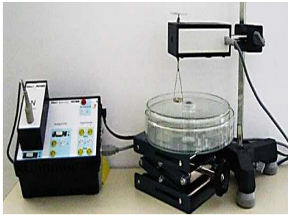
Рис. Д.12.1. Установка для дослідження процесу відривання кільця
