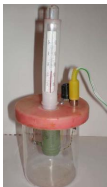
Рис. Д.11.1. Загальний вигляд установки для дослідження залежності опору металів і напівпровідників від температури
